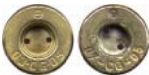
7,62-hylser fra Lapua (venstre) og Vanäsverken (høyre), begge med to tennkanaler og uten ambolt.
