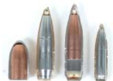
Blyfrie prosjektiler. Fra venstre: 9 mm NM233, 7,62 mm NM231, 7,62 mm NM232 (sporlys), 5,56 mm NM229.
